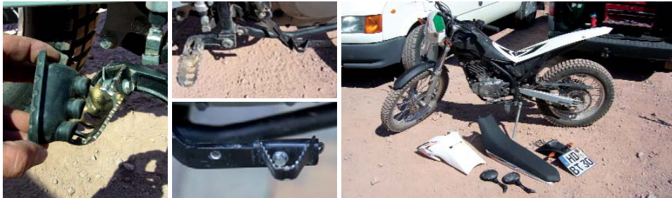
Die Gummis müssen im Gelände natürlich raus. Oben die provisorische Lösung, unten die Bessere. Bis dahin geht es schnell, die Rasten mitsamt den Haltern zu drehen dauert etwas länger, lohnt sich aber.
