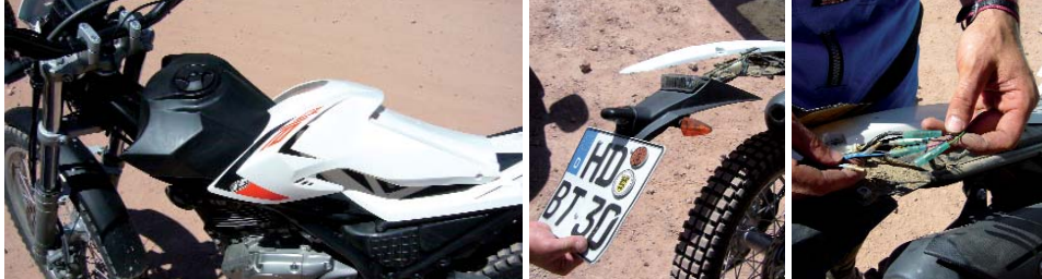
Eine rein kosmetische Sache ist das Entfernen der Tankverkleidung um Sturzkratzer darauf zu vermeiden. Das Kennzeichen sollte mit samt Halterung ab, was ... Die Steckverbinder problemlos möglich machen.
